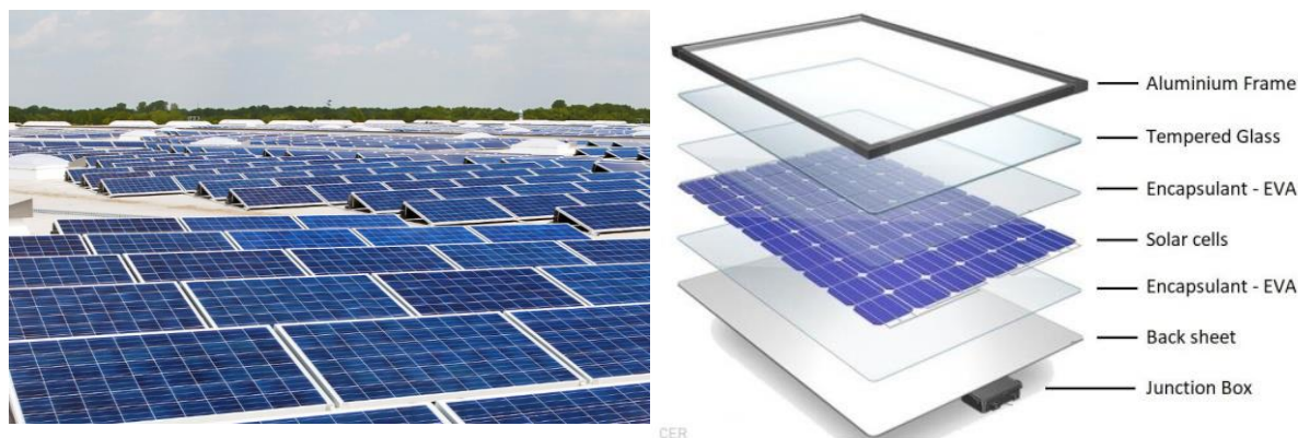
Figuur 8. Zonnepaneel opbouw bestaande uit: Aluminium frame, getemperd glas, zonnecellen met coating, achter paneel en aansluitkast.
